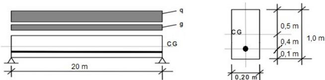
Dimensões da viga e posição das cordoalhas de protensão
