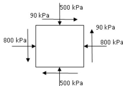
Tensões em um elemento plano de solo
