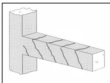
Esquema de fissuras em uma viga de concreto armado (HELENE, 2000)
