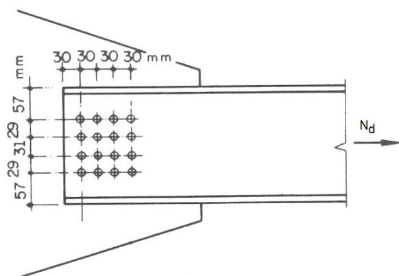
Ligaçāo metálica parafusada (PFEIL, 2000)
