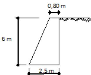
Dimensões de um muro de arrimo.
